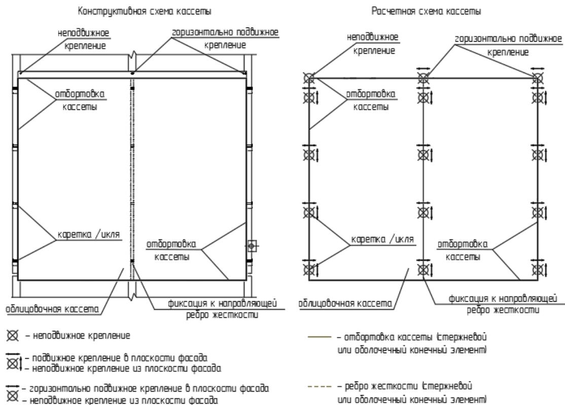
**Рисунок 11.3 – Пример конструктивной и расчетной схем облицовочного элемента**
