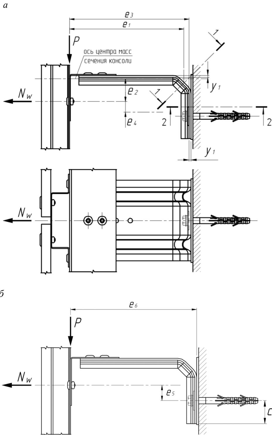
**Рисунок Ж.5 – Места приложения нагрузок и положение расчетных сечений элементов L-образного стального кронштейна с горизонтально ориентированной плоскостью консоли**
