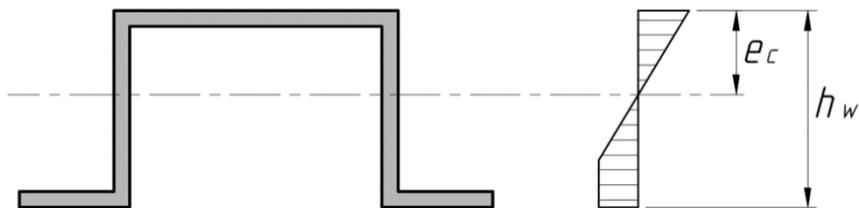
Рисунок 7.10 – Значение  $e_c$  для определения эффективной толщины стенки
