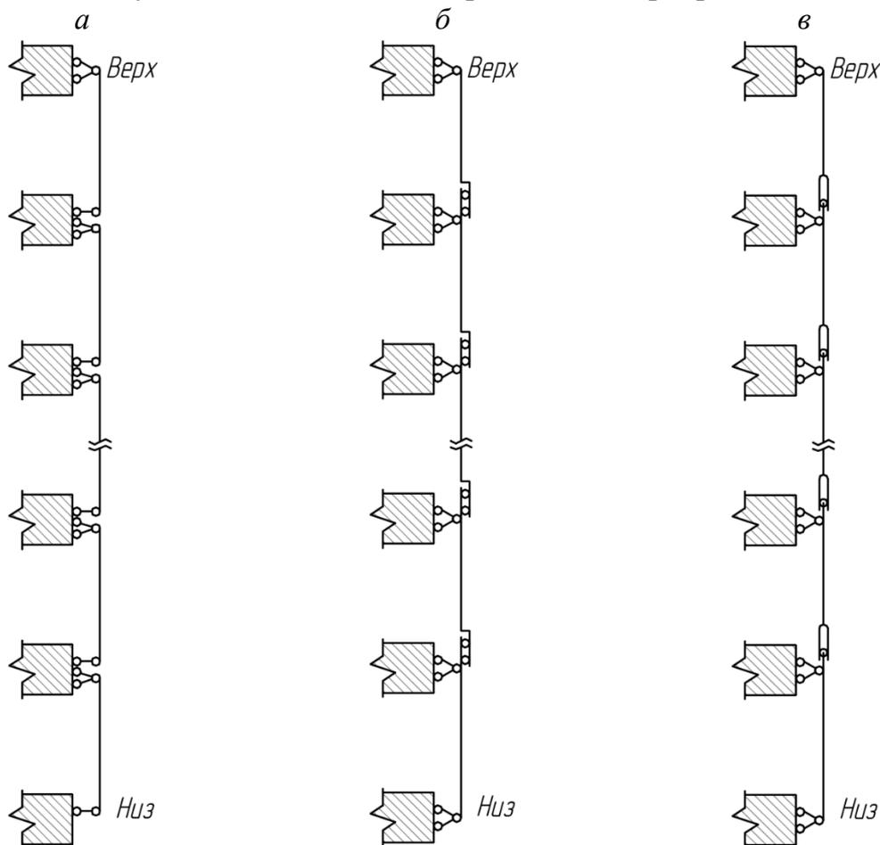
*a* – разрезные однопролетные балки; *б* – консольно-шарнирные балки, допускающие передачу поперечных сил и момента и исключающие передачу продольных сил; *в* – консольно-шарнирные балки, допускающие передачу поперечных сил и исключающие сопротивление моментам и продольным силам
