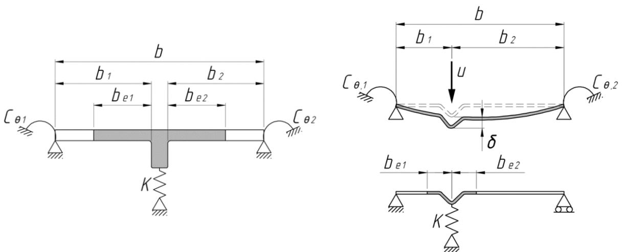
**Рисунок 7.7 – Виды усиления плоских пластинок промежуточными ребрами жесткости.**
