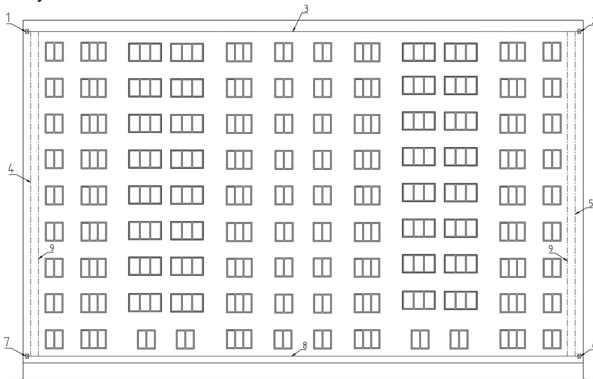
1 – первый кронштейн; 2 – второй кронштейн; 3 – натянутая леска с последующей установкой кронштейнов; 4 – установка первого отвеса; 5 – установка второго отвеса;
