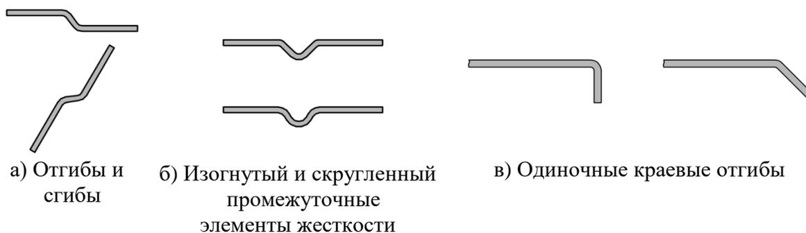
**Рисунок 7.4 – Типичные формы элементов жесткости гнутых профилей**
