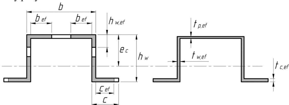
Рисунок 7.11 – Эффективное поперечное сечение при действии равномерного сжатия
