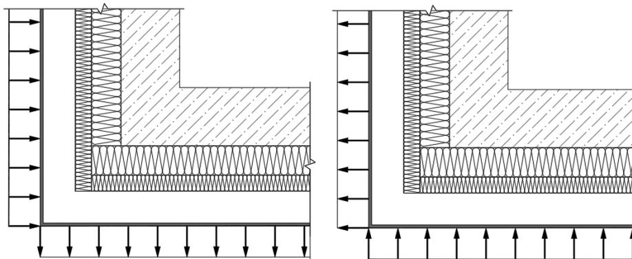
*Рисунок 11.5 – Действие ветровой нагрузки в угловой зоне фасада*
