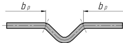
г) Расчетная ширина  $b_p$  прямых частей, примыкающих к ребру жесткости полки
