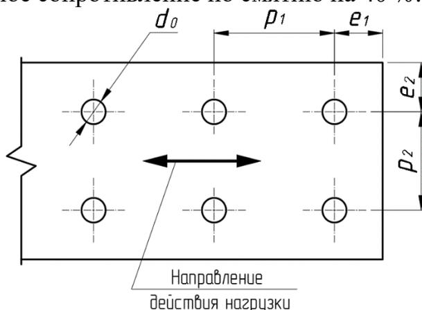
Рисунок 10.1 – Расположение точек крепления в соединениях
